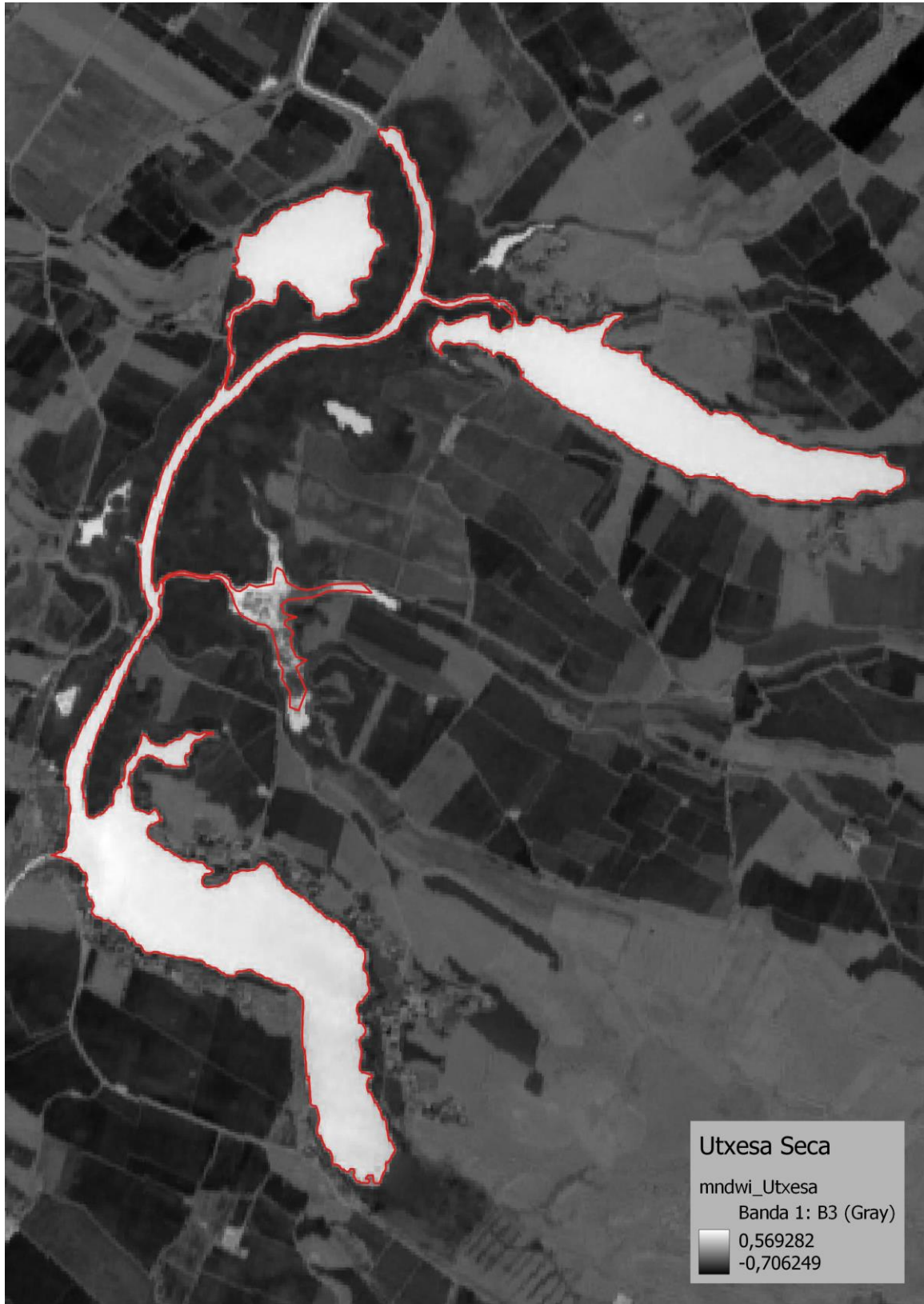
Figura 3. Índice NDWI aplicado a la imagen satélite para identificar la lámina de agua.
