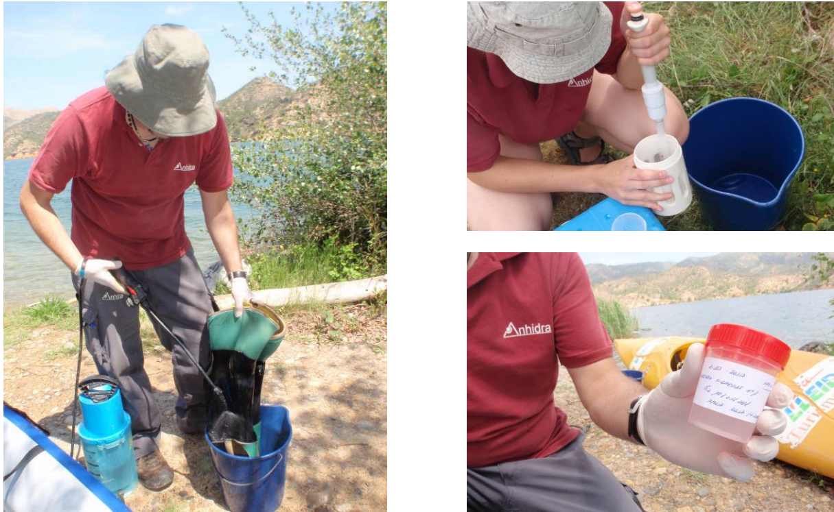
Figura 7.- Recogida de muestras: limpieza del implemento, trasvase al recipiente estéril y etiquetado.
