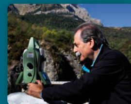
Auscultación topográfica de la coronación de la presa de Búbal.
