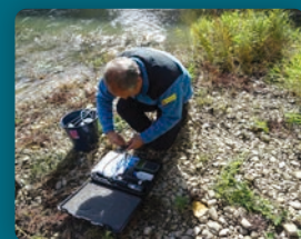
Medición de la calidad del agua con sonda multiparamétrica.
