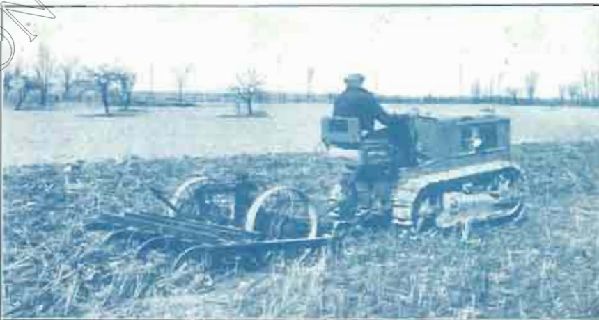
CATERPILLAR, 2 TONELADAS CON CULTIVADOR-ESCARIFICADOR "KILLDEER" DE 1,50 M. DE ANCHO
